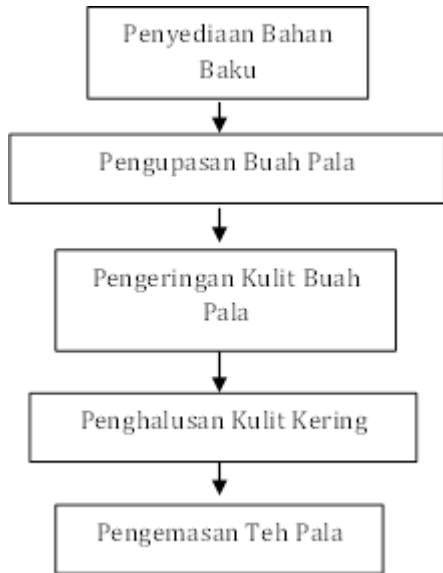
Gambar 5. Alur proses produksi teh pala
