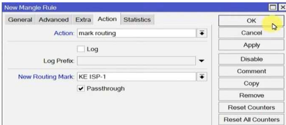
Gambar 11. Konfigurasi Mark Routing untuk pengatur ISP
