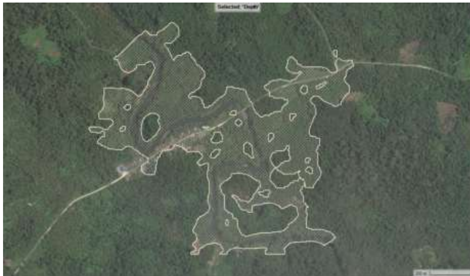
Gambar 9. Luas genangan yang terjadi untuk banjir kala ulang 5 tahun
